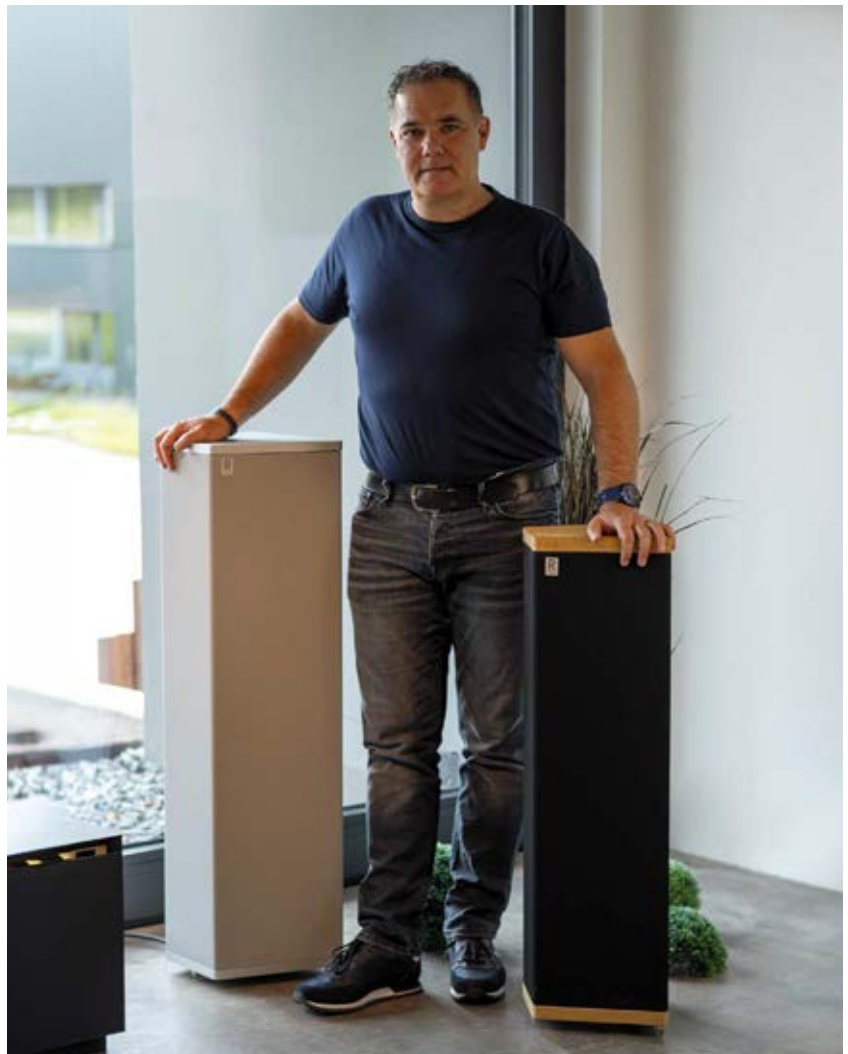
OHNE BASSREFLEX: Chefentwickler Yvo Aebischer baut seine Rowen-Lautsprecher – hier die Symphony 8 links und die Symphony 4 rechts – stets in geschlossene Gehäuse. Dieser Konstruktion traut er den wesentlich präziseren Bassbereich zu.
