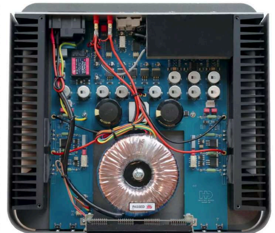
KLUGE KONSTRUKTION: Das Innenleben zeugt von durchdachter Ökonomie. Die Leistungstransistoren-Paare für jeden Kanal flanschen direkt an den beidseitigen Kühlkörpern an.
